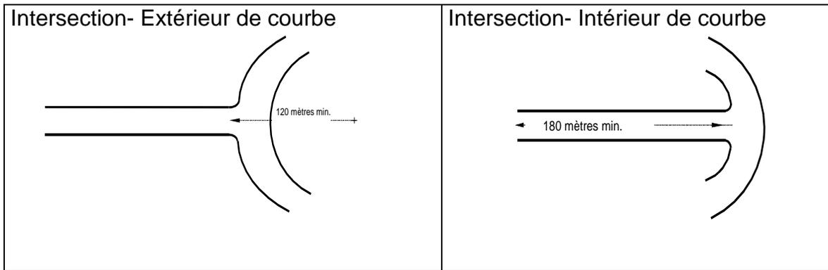
Aucune courbe dont le rayon intérieur est inférieur à 90 mètres n'est permise à moins de 35 mètres d'une intersection (voir figure 6.2.4b) ;
