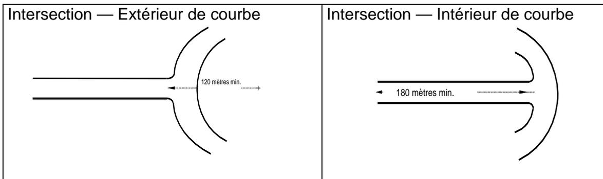
3. Aucune courbe dont le rayon intérieur est inférieur à 90 mètres n'est permise à moins de 35 mètres d'une intersection (voir figure 6.2.4b);
